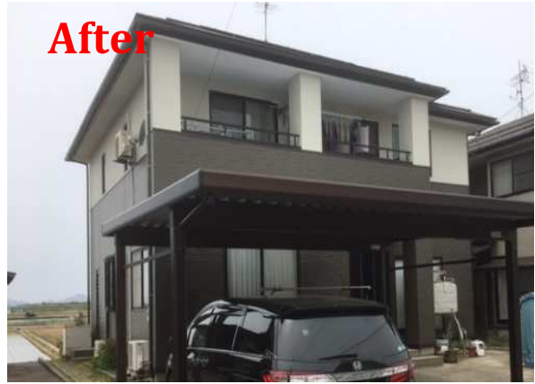
IGサイディング重ね張り 破風・軒天・屋根塗装 雨樋交換
