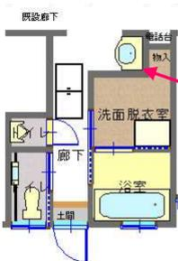
↑着替え中は、洗面が使えないので脱衣所とは別に廊下へ設置。壁面は**水に強く掃除しやすいキッチンパネル**にしました。
